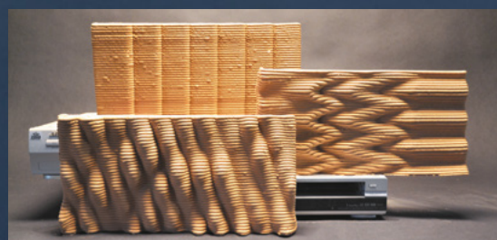
Échantillons texturés en terre crue imprimée en 3D avant l'essai d'érosion hydrique.
